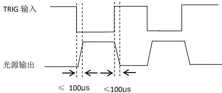
**常灭模式：**当外部连接触发信号时，触发“Trx”“COM”输入端口断开(低电平)，光源常灭；“Trx”“COM”输入接+5V到+24V（高电平），光源常亮。
