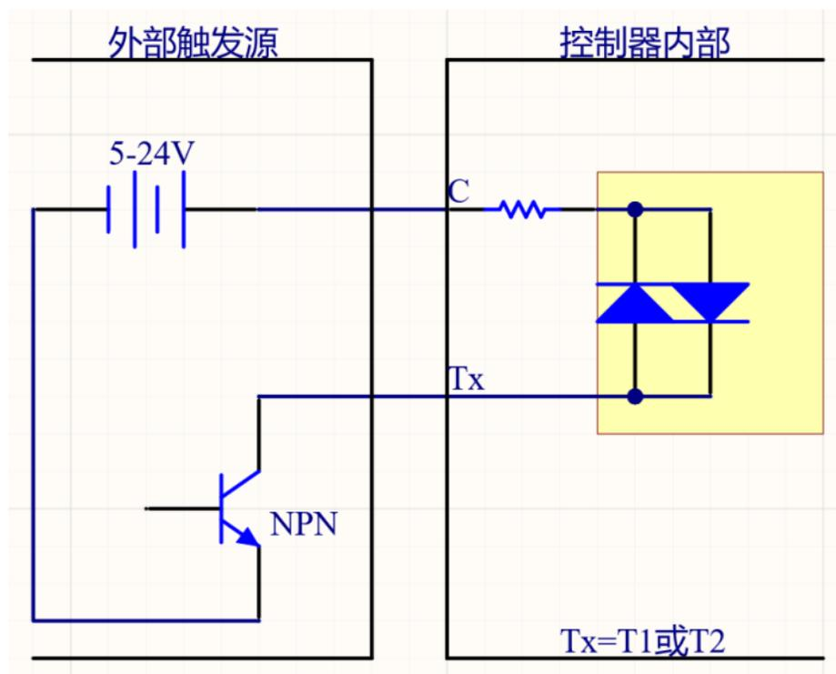
注：触发电平为 DC 5~24V，如果不需要硬件触发功能可以不接。
